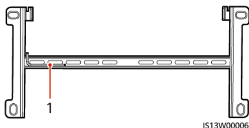
Rysunek 4-8 Pozycja umieszczania klucza typu Torx
