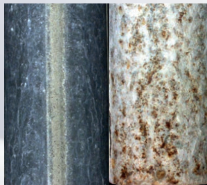
Magnelis® ZM310 spawanie z odtworzeniem powłoki ochronnej
