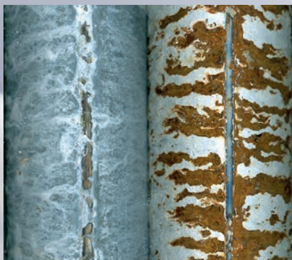
Magnelis® ZM120 spawanie bez odtworzenia powłoki ochronnej
