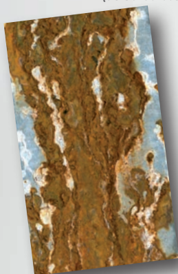
Cynkowanie ogniowe 20 µm po 6 tygodniach
