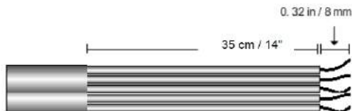
Ilustracja 39: Usuwanie izolacji – AC
