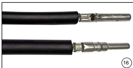
(rys. 16) Wizualnie skontrolować zaciskanie pod względem kryteriów opisanych w IEC 60352-2:2006 + A1:2013
