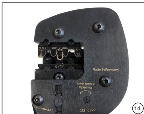
(rys. 14) Lekko docisnąć szczypce, tak aby końcówki zaciskowe znalazły się wewnątrz wnęki szczęk zaciskowych.
