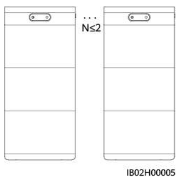
Rysunek 2-5 Połączenie równoległe
